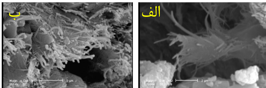
تصویر ۱- میکروگراف الکترونی روبشی (SEM) نشان دهنده وجود مقدار فراوان پالیکورسکایت مارن گچی میوسن (الف) و عمق ۸ متری مقطع لسی (ب)
