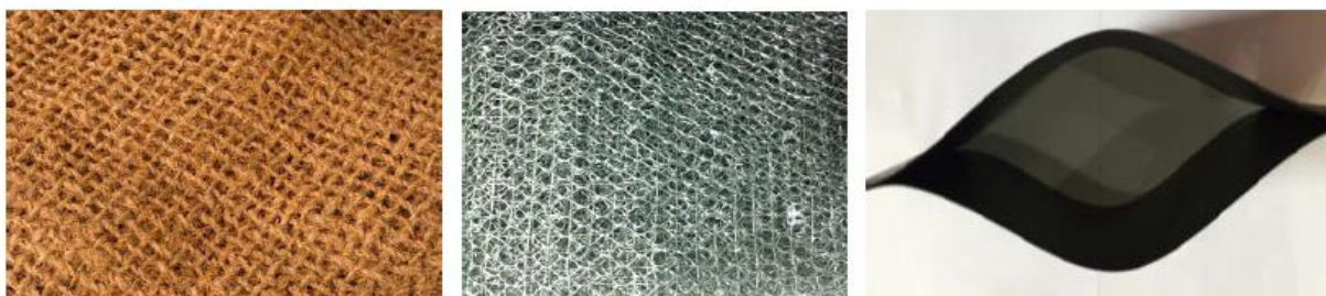
شکل ۱- انواع ژئوتکستایل های طبیعی - مصنوعی
