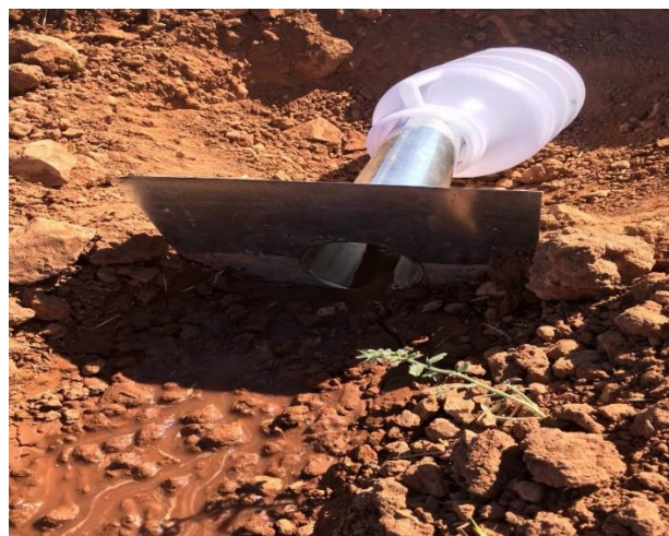
شکل ۲. نمایی از آزمایش تولید رواناب و رسوب در شیارهای ایجاد شده
