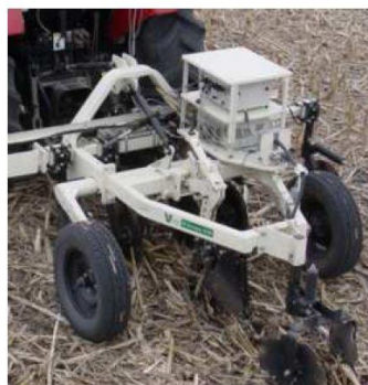
شکل ۱- ساختمان یک طیف سنج میله ای برای اندازه گیری طیف های نزدیک
