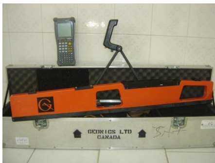
شکل (۱) نمایی از دستگاه القاگر الکترومغناطیس از نوع EM-38 و ساخت شرکت ژئونیکس کانادا
