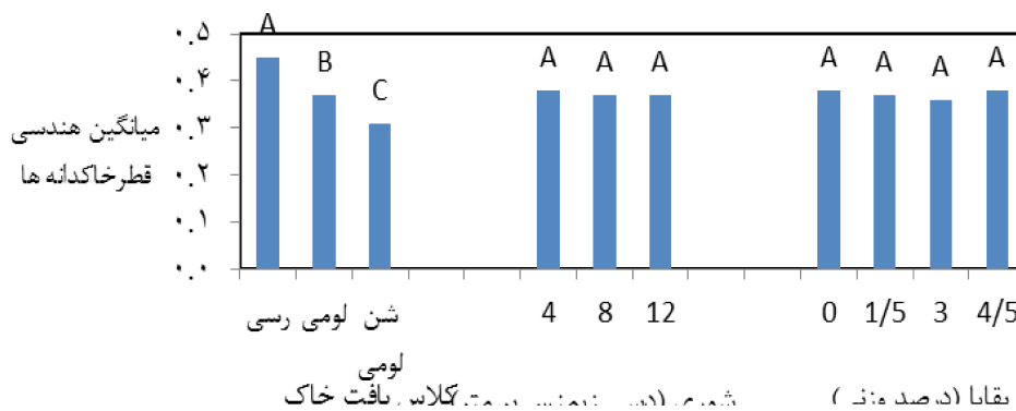
شکل ۲- اثر بافت خاک، سطوح شوری و بقایای پسته بر متوسط میانگین هندسی قطر (میلی‌متر) خاکدانه‌ها (اندازه‌گیری شده به روش الک خشک)
